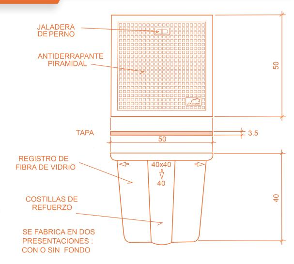
ACOTACIONES EN CENTÍMETROS TOLERANCIA +- 3 mm
